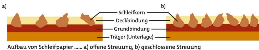
Obr. 1: Skladba brusného papíru a) otevřený posyp, b) uzavřený posyp (z odbornosti dřevařské technologie, 24. Edition Publisher Europe Teaching Materials)
